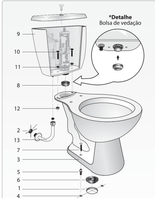
BACIA COM CAIXA ACOPLADA - DUPLO ACIONAMENTO
