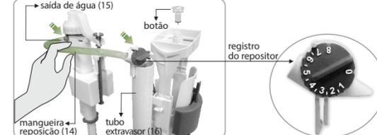
Instale a mangueira de reposição (14), conforme figura acima. Encaixe uma ponta na saída de água (15) do mecanismo de entrada e a outra extremidade deve ser encaixada no tubo extravasor (16).
