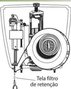
BACIA COM CAIXA ACOPLADA - DUPLO ACIONAMENTO
